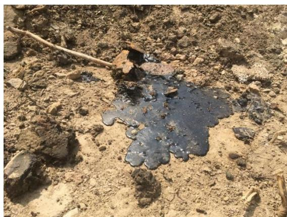
**Abb. 2: Alte Teerleitungen und flüssige Teerrückstände auf einem ehem. Gaswerksstandort, die bei den vorangegangenen Erkundungen nicht detektiert wurden.**
