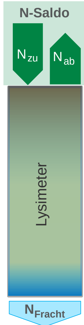
Abb. 5: Schematische Darstellung der N-Bilanz- komponenten auf Lysimetern.
