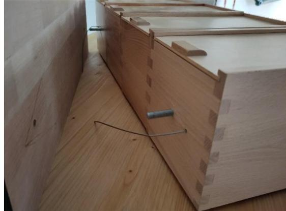
Dabei darauf achten, dass die beiden Bowdenzüge zwischen der Rückwand und den Rückwänden der Boxen festklemmen, so dass die Blätter nicht einfach durch die Frontöffnung gezogen werden können.
